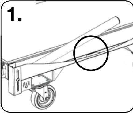
**1.** Les bras de support se relèvent pour être utilisés comme poignées ou comme support de charge ou se replient sous la surface utile du chariot pour accueillir des charges encombrantes. Les bras de support sont équipés d'emplacements pour les doigts afin de faciliter les changements de position.
