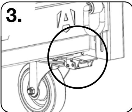
**3.** Les deux roues arrière sont équipées d'un système de blocage de direction pour permettre de diriger le chariot dans une seule direction.
